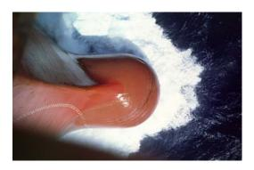
De bulb onderaan de boeg van het schip doorklieft het water van de Oceaan.
