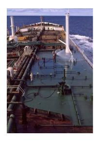
Het onderhoud aan het hoofddek in volle gang. Alvorens er weer een verflaag werd aangebracht werd het te verven gedeelte 'afgezoet' met zoetwater
